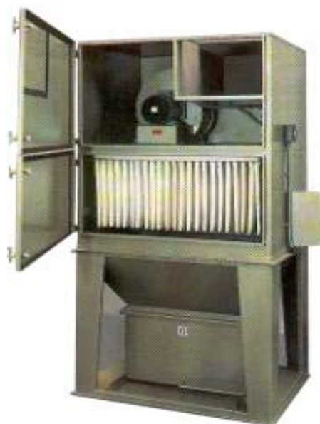
Filtre à poches . Secouage manuel . Secouage motorisé
